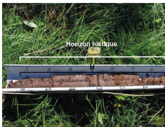
Figure 11: Exemple d'examen d'un sol à partir d'un sondage pédologique. Source : MEDDE, GIS Sol. 2013. Guide d'identification et de délimitation des sols de zones humides. Ministère de l'Écologie, du Développement Durable et de l'Énergie, Groupement d'Intérêt Scientifique Sol, 63 pages.
